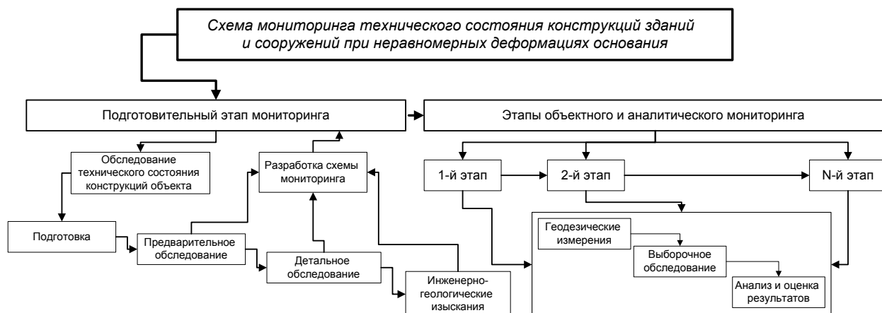
Рис. 1. Схема мониторинга технического состояния конструкций зданий и сооружений при неравномерных деформациях основания.
