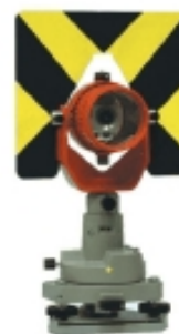
Рис. 8. Однопризмный отражатель с визирной маркой.
