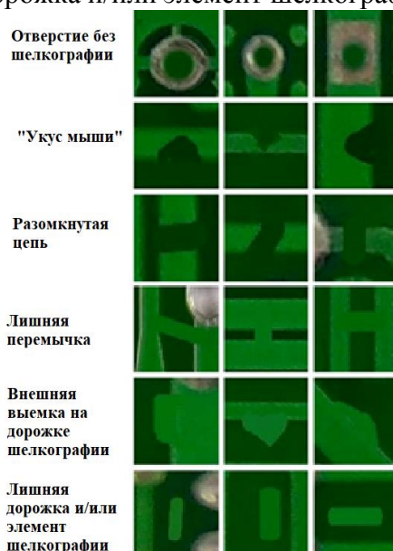
Рис. 2. Виды обнаруживаемых дефектов
