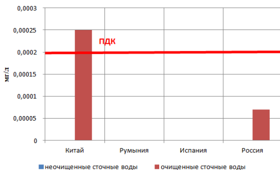
Рисунок 3. Концентрация антибиотика Эритромицин в неочищенных и очищенных сточных водах в разных странах
