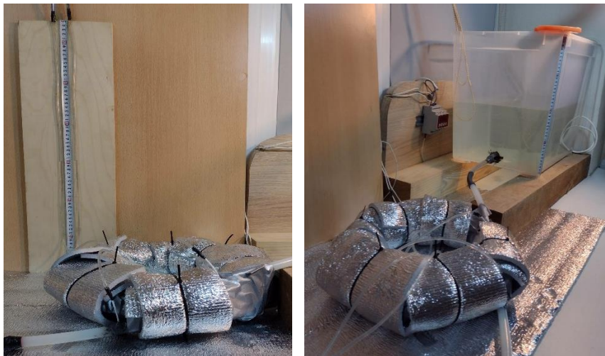
Рисунок 1. Фрагменты установки с пьезометром (слева) и с мерной емкостью и терморегулятором (справа)
