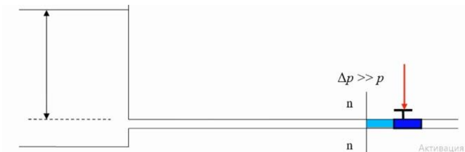
Рисунок 1. Схема возникновения гидравлического удара в трубопроводе
