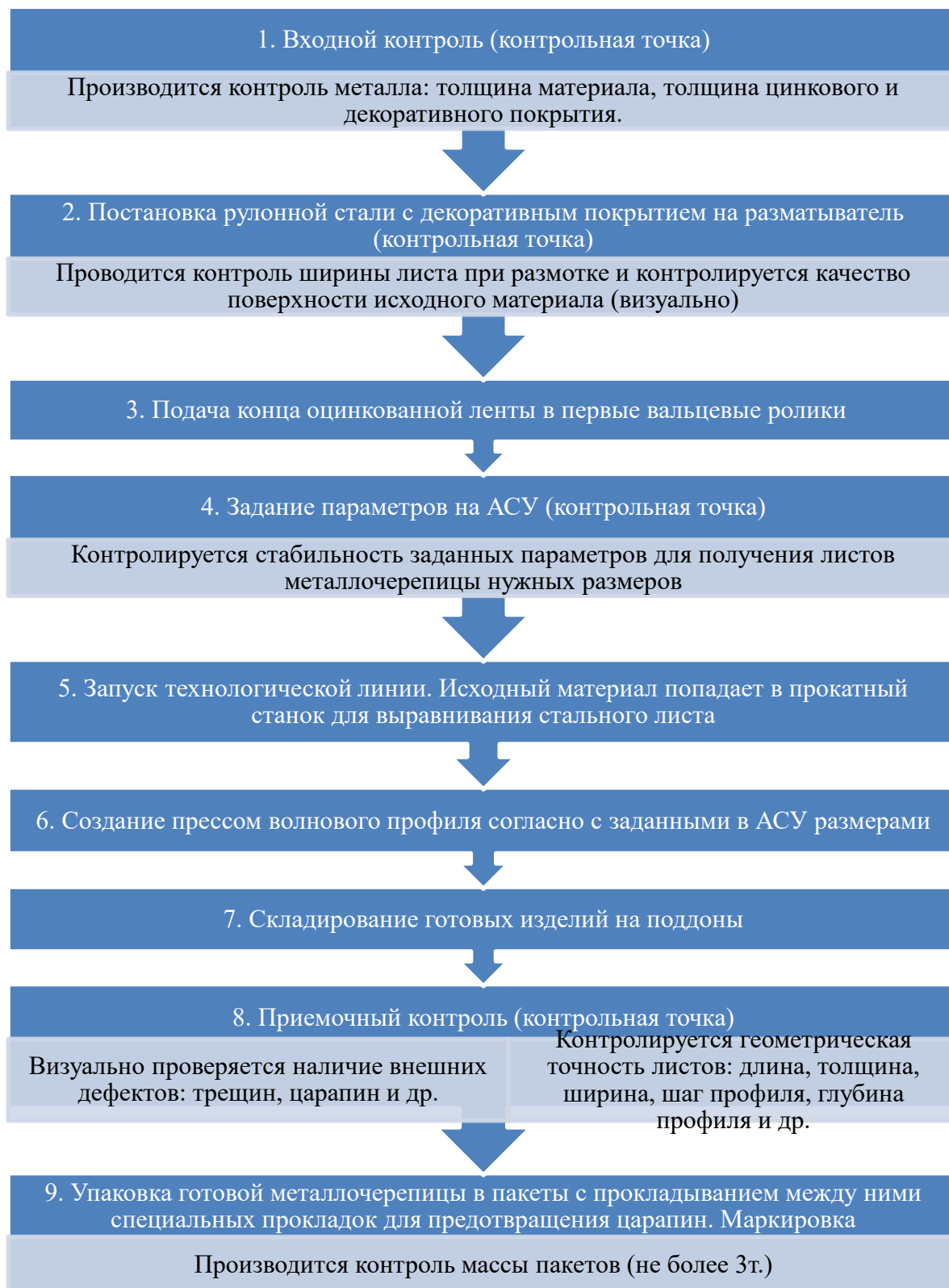
Рисунок 1. Контролируемая система процесса производства металлочерепицы
