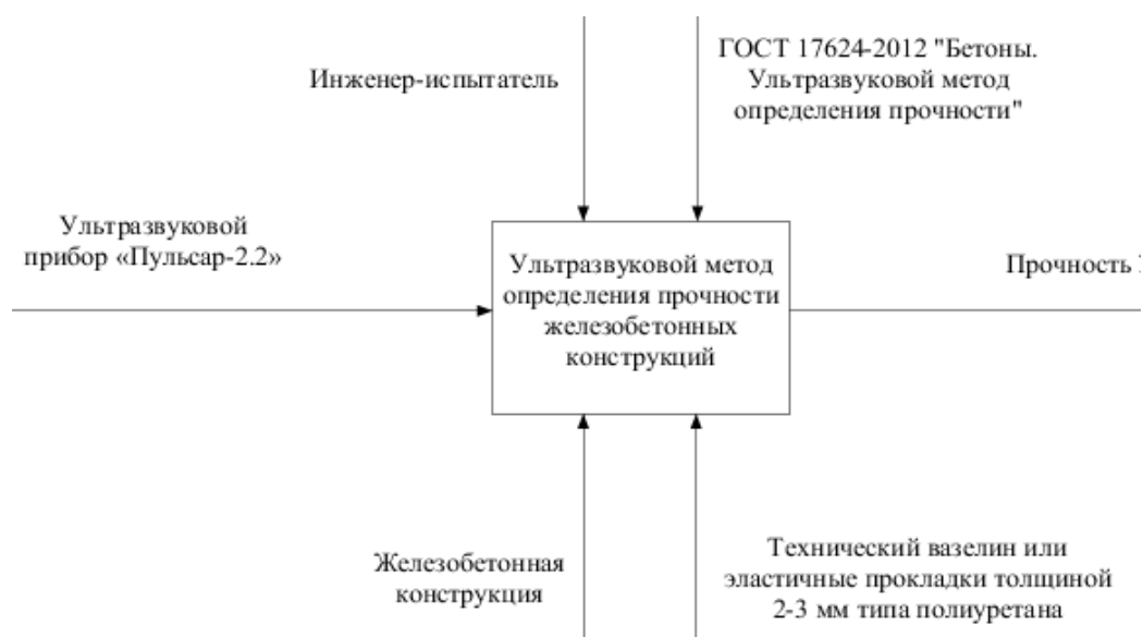
Рисунок 1. Входные данные и выходной параметр при проведении испытания
