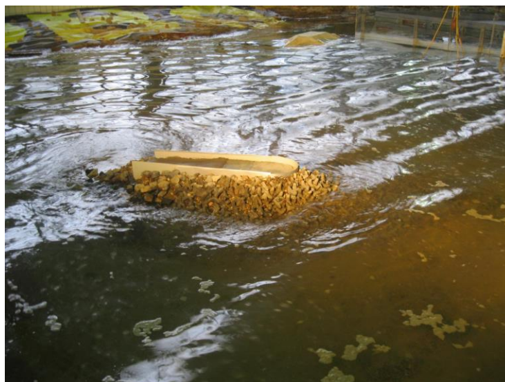
Рисунок 11. Фотография волнового поля физической модели между двумя оголовками молов
