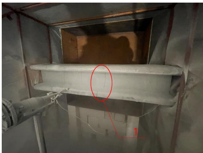
Рисунок 2. Общий вид Образца после криогенного воздействия: 1 - зона наибольшего повреждения образца
