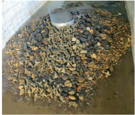
*Рис. 5. Визуализация эксперимента в волновой лотке и его результат*
