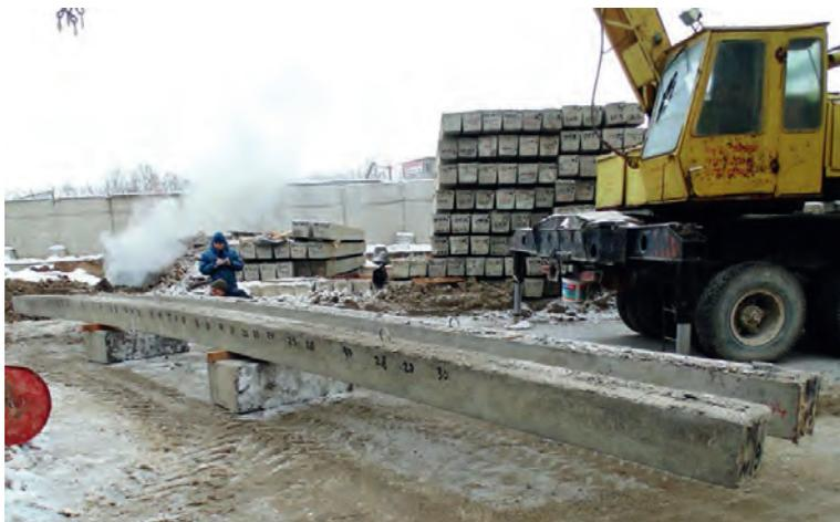
Рис. 2. Проведение заводских испытаний свай
