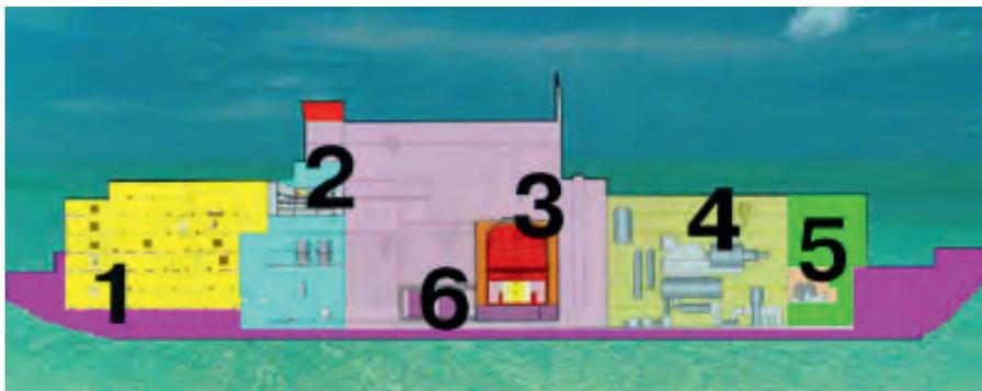
Рис. 1. 1 — жилой отсек, 2 — цит управления ПАЭС, 3 — реактор, 4 — паротурбинная установка, 5 — электротехнический блок, 6 — хранилище отработавшего ядерного топлива
