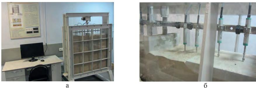
*Рис. 1. Автоматизированный стенд ГТ 0.7.1 с моделями фундаментов и грунтовым основанием: а — общий вид стенда; б — расположение моделей фундамента под опору моста и сплошного фундамента*
