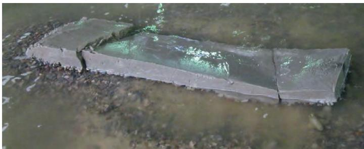
*Рис. 4. Разрушение плиты на модели головы Южного мола*
