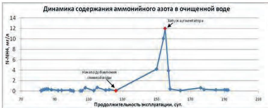
Рис. 2. Динамика содержания аммонийного азота в очищенной воде
