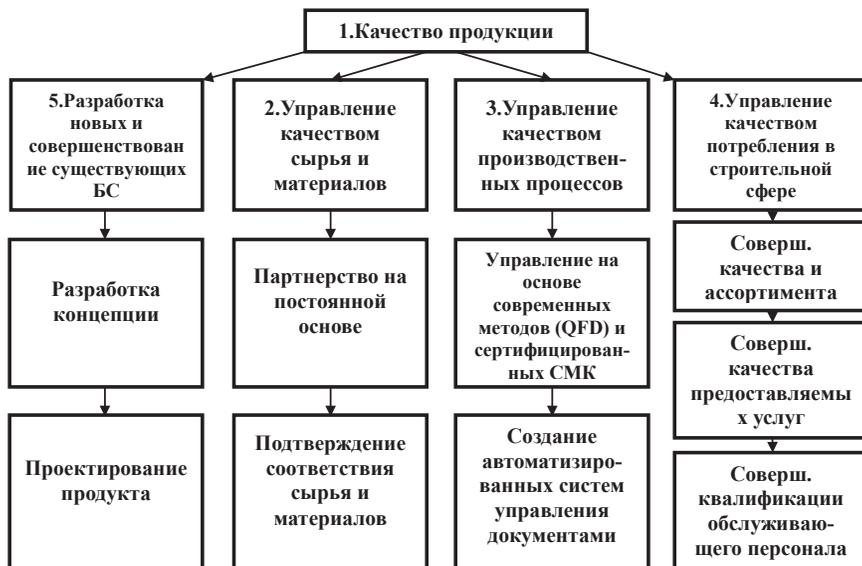
Рис. 1. Схема управления качеством бетонных смесей
