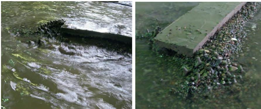
*Рис. 3. Характер волнового разрушения модели головы Южного мола*
