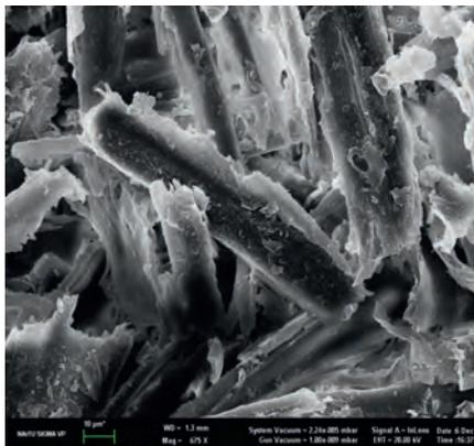
Рис. 3. Электронная фотография микродиспергированной древесины
