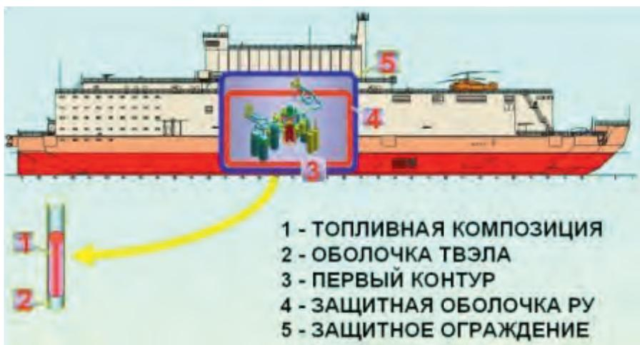
Рис. 2. Схема защиты АЭС
