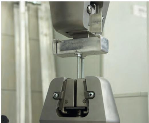
*Рис. 5. Общий вид установки с образцом для испытания узлового соединения*
