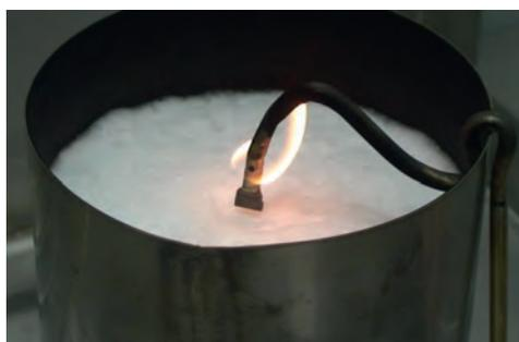
*Рис. 2. Иллюстрация процесса определения времени воспламенения гептана из под слоя низкократной пены. Факел пламени поддерживается непрерывной подачей горячего газа*
