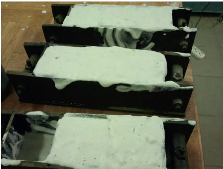
*Рис. 1. Процесс формования пеногипсовых образцов*
