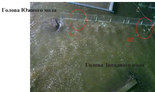
*Рис. 1. Исследование устойчивости откосов с защитной наброской из тетраподов 13т*
