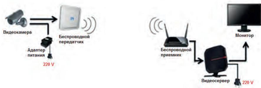
*Рис. 4. Беспроводной способ передачи видеоизображения*
