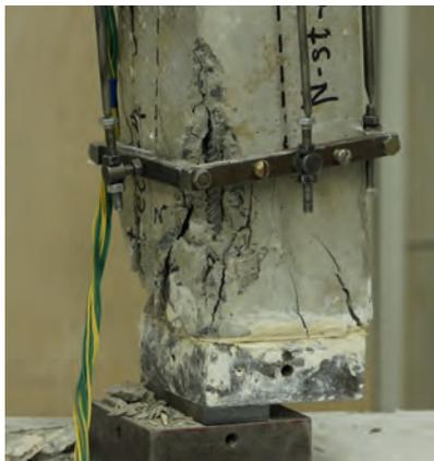
Рис.2. Разрушение внецентренно сжатой железобетонной колонны в нормальных условиях
