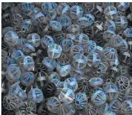
*Рис. 5. Шаровидная полимерная загрузка*
