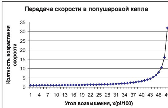
Рис. 4. Увеличение скорости жидкости в полушаровой капле
