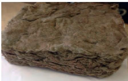
*Рис. 3. Образец теплоизоляционного материала на минеральном связующем, полученный в лабораторных условиях*
