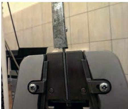
Рис. 10. Деформация тонкого образца при действии нагрузки
