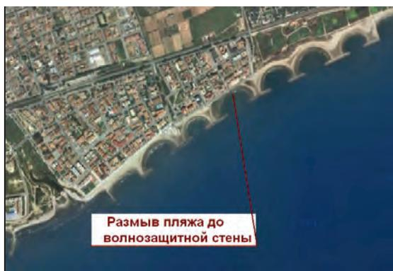
*Рис. 1. Пляжи бухтового очертания с искусственными мысами под защитой волноломов (Франция)*
