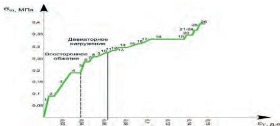
Рис.5. График зависимости между средними напряжениями  $\sigma_m$  и объемными деформациями  $\varepsilon_v$
