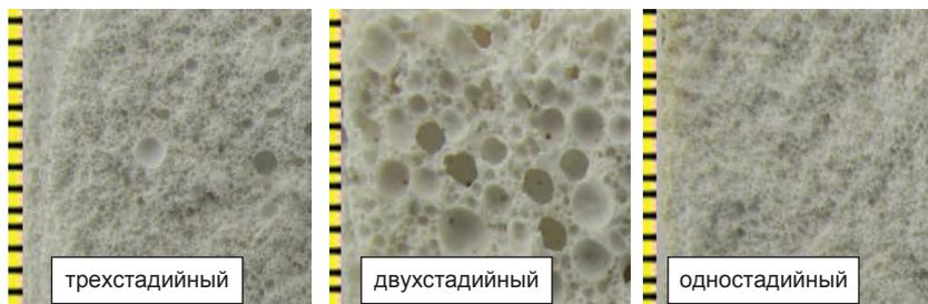
Рис. 2. Влияние способа приготовления на структуру магниального пенобетона
