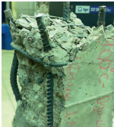
Рис.3. Разрушение внецентренно сжатой железобетонной колонны при температуре 500°С
