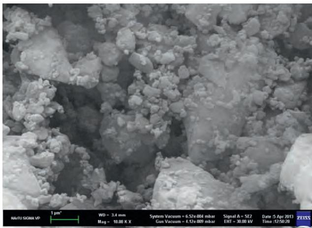
Рис. 2. РЭМ образца песка (№3) со средним размером частиц 304±106 нм
