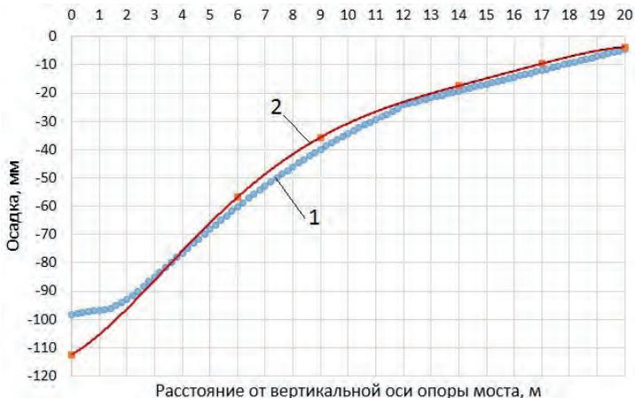
Рис. 3. Графики изменения величин осадок в зависимости от расстояния до вертикальной оси опоры моста, полученные:
