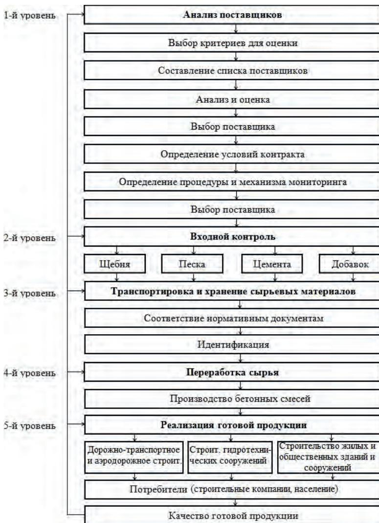
Рис. 2. Многоуровневая иерархическая система управления качеством бетонных смесей
