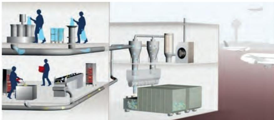
*Рис. 1. Схема работы пневматического сбора мусора.*
