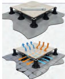
под уклоном через воронки. Свободное пространство обеспечивает циркуляцию воздуха под покрытием, что способствует высыханию поверхности гидроизоляции и, соответственно, увеличению ее срока эксплуатации.
