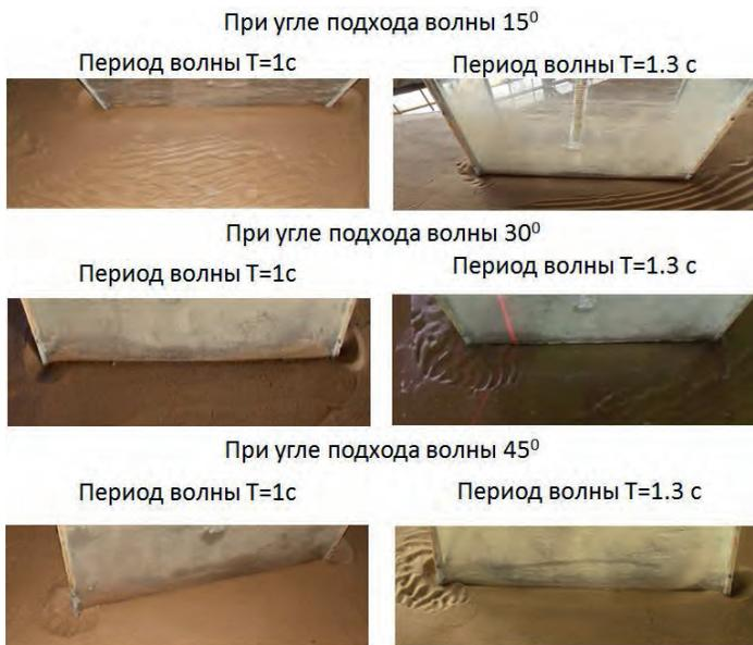
*Рис. 5. Воронки размыва от косоподходящих волн при различных углах подхода волны к сооружению*
