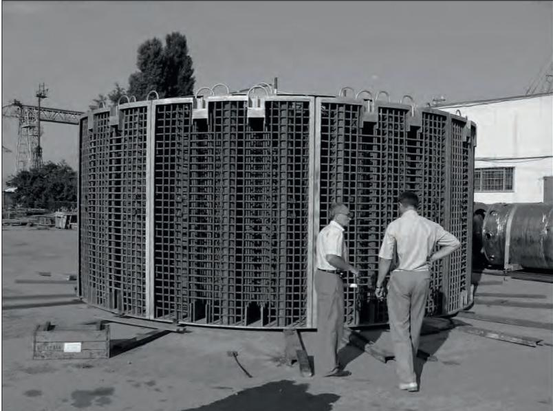
*Рис. 1. Металлоконструкция сборной сухой защиты реактора*
