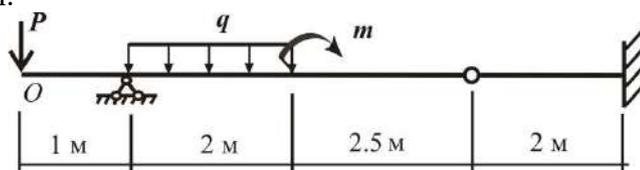
Задача 2. Для заданной балки определить прогиб в точке D и угол поворота в точке B с помощью интеграла Мора.
